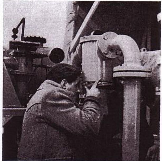
Bild 2 Der schallerzeugende Teil der Sirene.
