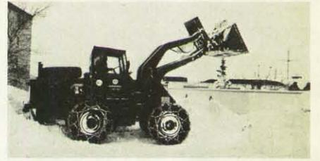
Bestens bewährt hat sich bei der Bewältigung der Schneemassen der Schwenkschaufler, hier ausgerüstet mit Schneeketten.
